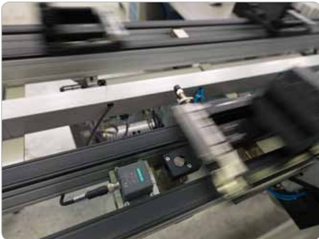
Obr. 1 Identifikácia paletky pomocou RF300
