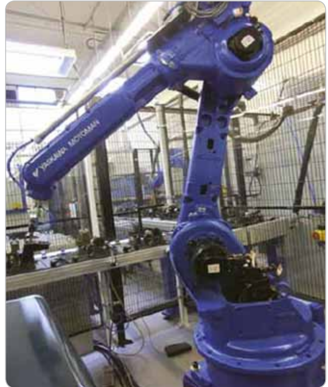
Obr. 1 Bunka s robotom YASKAWA pre manipuláciu s dverovými zámkami.
