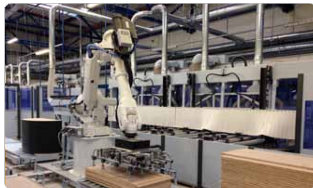
Obr. 1 Biely robot ABB IRB 6640 obsluhuje CNC zariadenie
